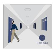
感应器检测不到运动后,自动进入延时时间,延时时间后自动关灯。
